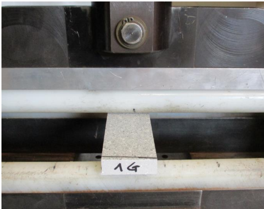
Figura 2. Campione del prodotto “Coprimumo in Marmoresina” durante la prova di resistenza a flessione post cicli di gelo e disgelo.
