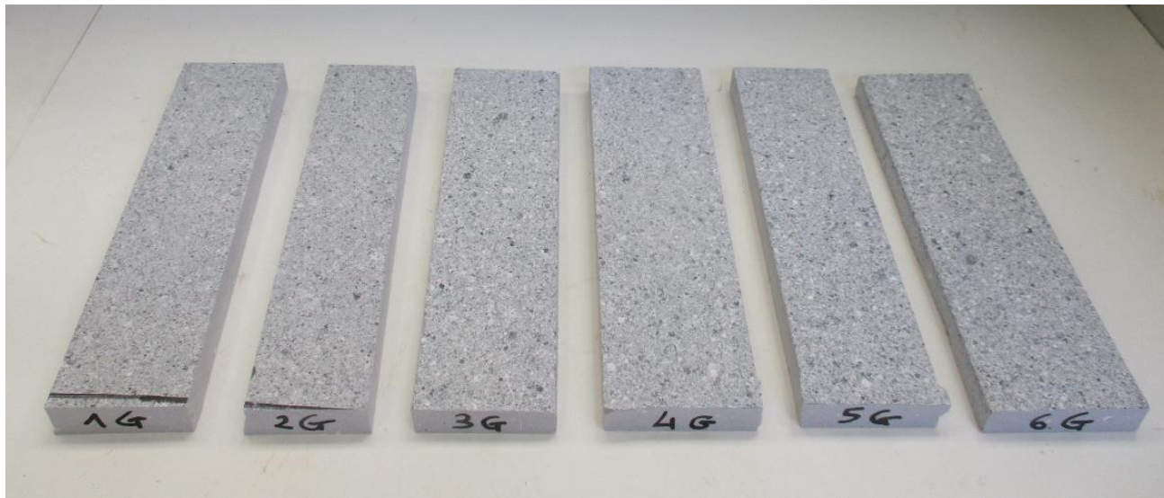
Figura 1. Provini del prodotto “Coprimuro in Marmoresina” così come fatti pervenire dal Committente (di dimensioni pari a 200 x 50 x 14 mm).
