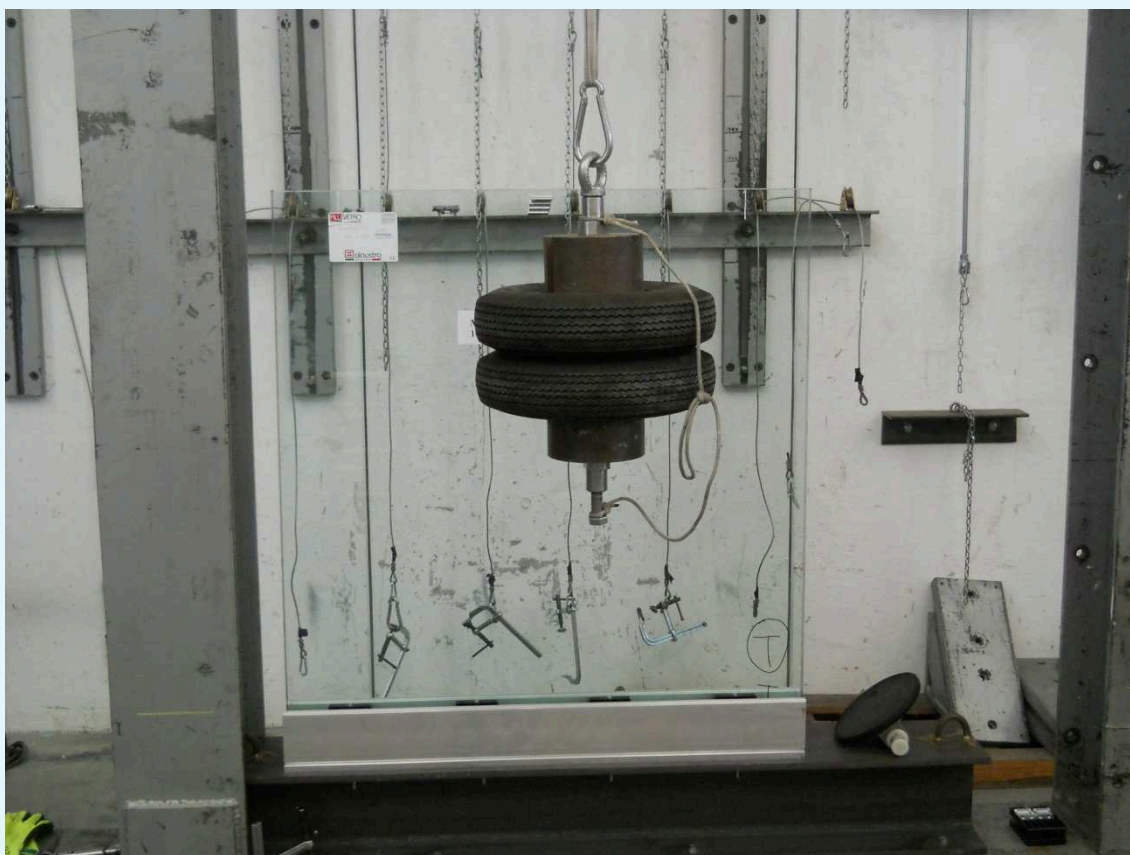
Fotografia del campione dopo l'urto.
