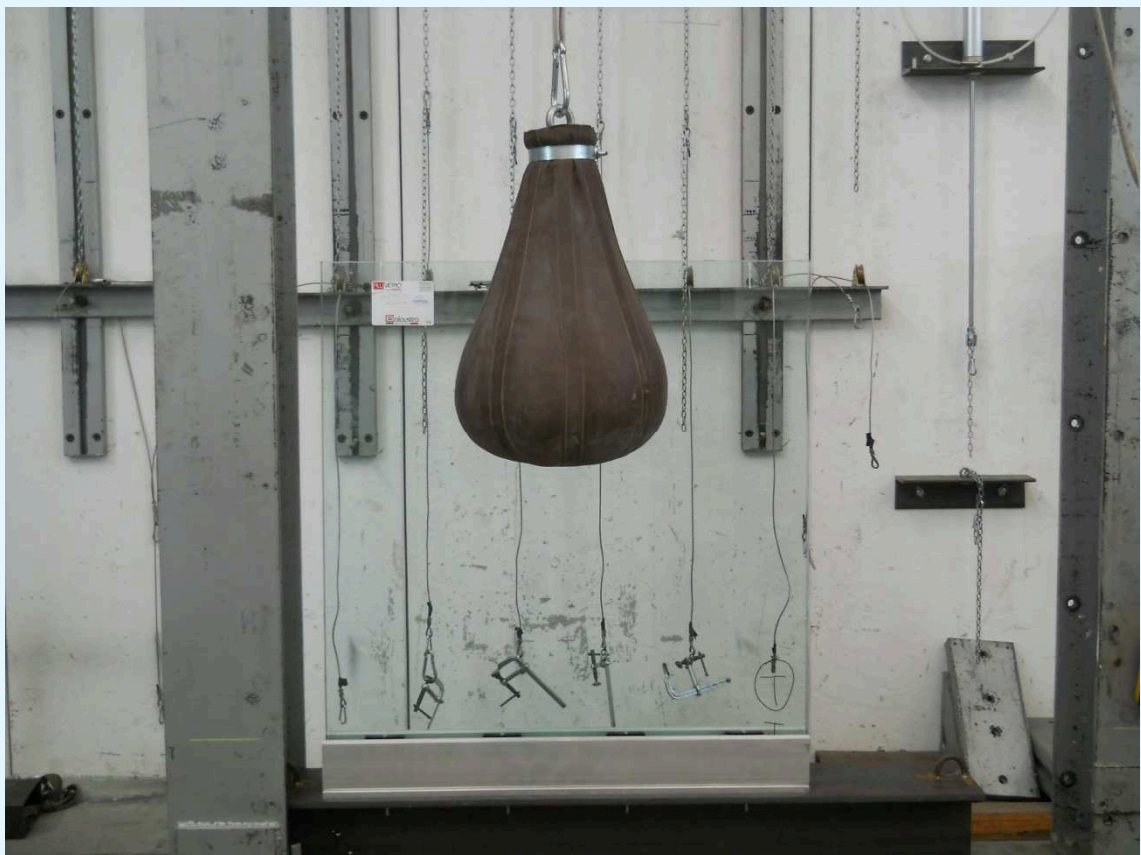
Fotografia del campione dopo l'urto.
